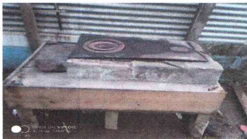
Foto 3: Sustitucion de polleton por estufa rural
